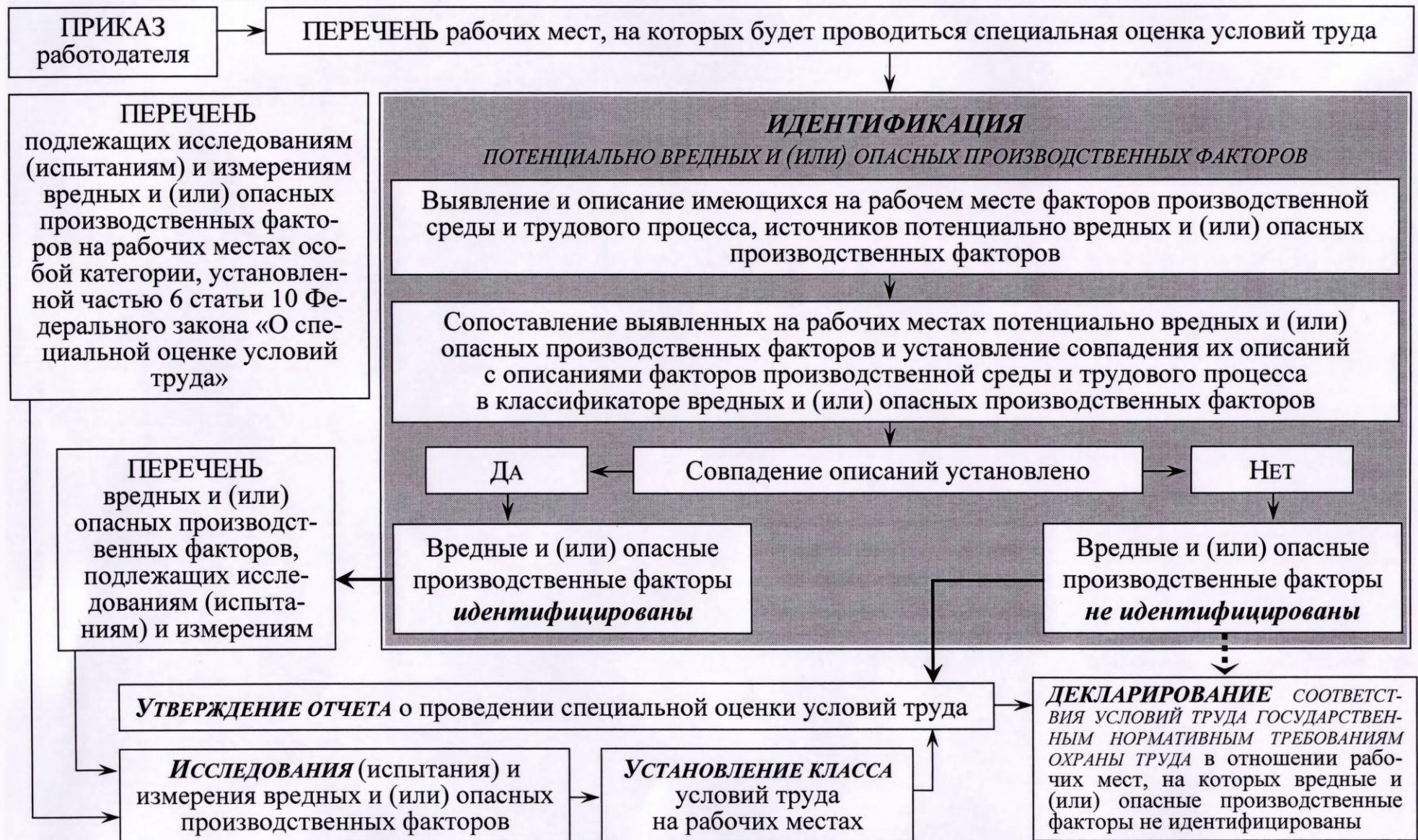
Рис. 1 – Блок-схема проведения специальной оценки условий труда
